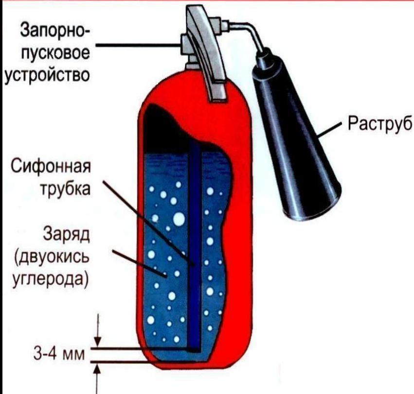
**ПРИНЦИП ДЕЙСТВИЯ** основан на вытеснении двуокиси углерода избыточным давлением. При открывании запорно-пускового устройства CO<sub>2</sub> по сифонной трубке поступает к растробу. CO<sub>2</sub> из сжиженного состояния переходит в твердое снегообразное. Температура резко понижается до -70°C. Углекислота, попадая на горящее вещество, изолирует его от кислорода.
